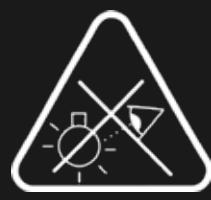
**Achtung! Risikogruppe 2:** Möglicherweise gefährliche optische Strahlung! Bei Betrieb nicht für längere Zeit in die Lampe blicken, weil das die Augen schädigen kann.
