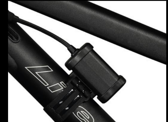
**Akkutypen:** Lupine HardCase Akkus verfügen auf der Rückseite über eine Lasche und werden mit einem Klettband befestigt.
